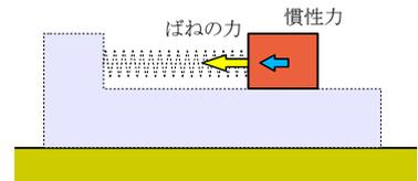
(1)、(2) より、物体の加速度  $a$  を  $A$  を含まない形で表すと  $a=-\frac{k}{m}x-\frac{kx}{M}$  だから  $a=-\left\{\frac{k(m+M)}{mM}\right\}x$  と表すことがで
