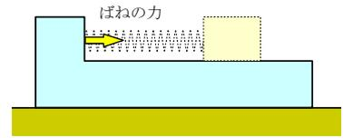
物体の位置が  $x$  [ $\text{m}$ ] のとき、台に働く水平方向の力は  $+kx$  [ $\text{N}$ ] より、床から見た台の運動方程式は  $MA=kx \cdots(1)$  である。
